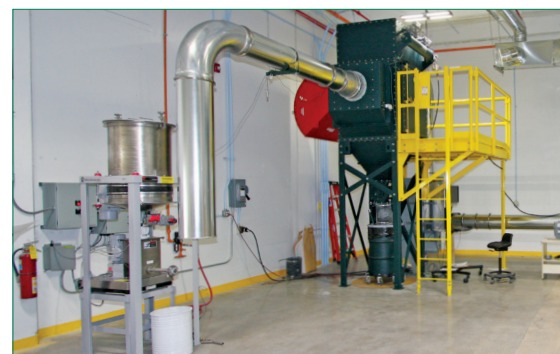
Banco de ensayos para pruebas según ASHRAE Standard 199
